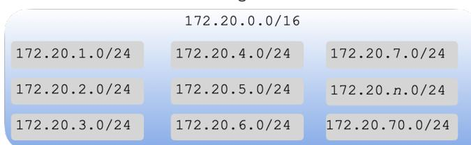
Figure 8: Structuration des réseaux IP de la SAE
